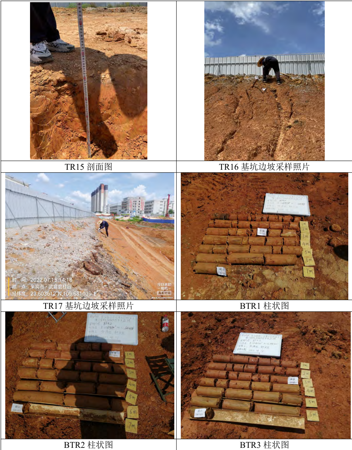
图 4.3-1 初步调查现场土壤柱状及剖面图
